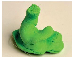
Fendas e falta de preenchimento
