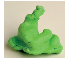
Falta de preenchimento da segunda curva
